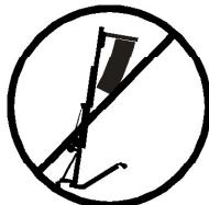
**3.5** - Comprobar que las patas estén situadas correctamente, y fijadas con los gatillos de seguridad los cuales deben estar introducidos y bloqueados.
