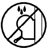
**3.14** - No engrasar ni lubricar el mecanismo de freno del cabrestante. Los discos de freno vienen engrasados con una solución especial resistente a la presión y al calor. No deben utilizarse otros productos, para evitar los efectos negativos sobre el mecanismo de frenado.
