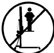
**3.1** - La HDT-8 es una máquina diseñada para la elevación de cargas en dirección vertical, NUNCA se debe utilizar como plataforma elevadora de personas.
