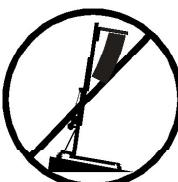
**3.2** - Colocar el elevador sólo en superficies firmes y planas, verificando que está en posición vertical, utilizando el indicador de nivel de burbuja que se encuentra en la base. Ajuste los estabilizadores (Q) girando las manivelas hasta nivelar, si es necesario. Nunca utilice cuñas u otros objetos extraños para equilibrar el elevador.
