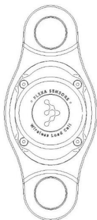
Fig. 15 – Cella di carico DynaCell - lato batterie – Viti acciaio
