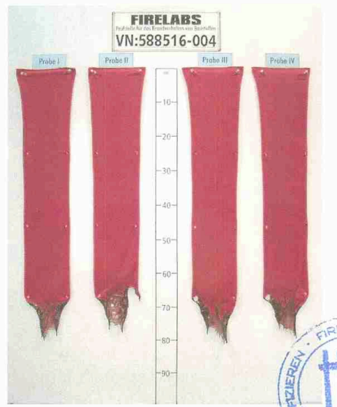
Bilde 8 Prøveeksemplarets utseende etter brannforsøket Fra venstre, prøve 1, prøve 2, prøve 3 og prøve 4
