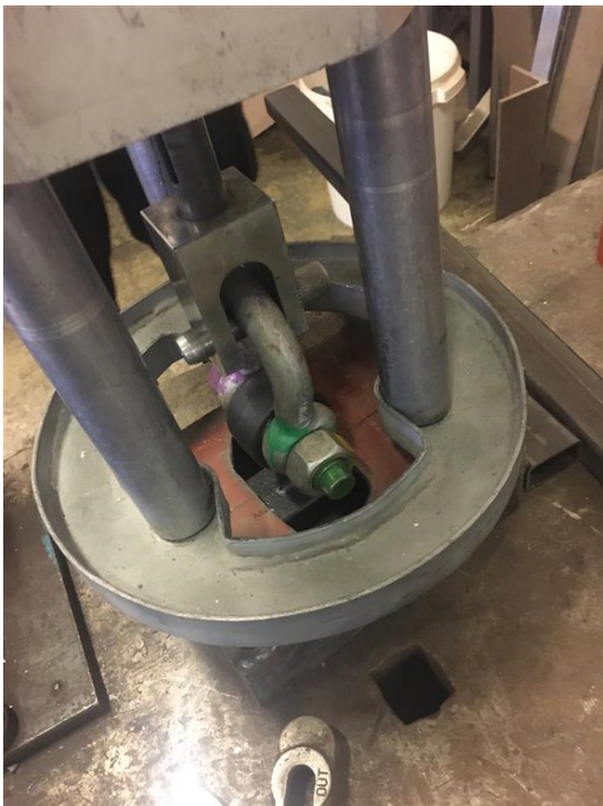
Testlast: 2000kg Ok, deformert 2500kg
