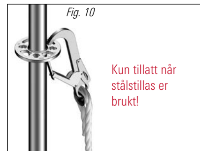
Fig. 10: Gjelder kun stålstillas: Å bruke rosettkransen som festepunkt er tillatt både i de store og små hullene. (ikke tillatt på aluminiumstillas!)
