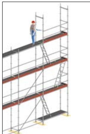
Festepunkt i rekkverkshøyde
