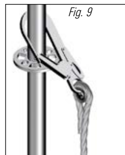
Fig. 9: Tillatt festepunkt: Rund et spir, rett ovenfor rosettkransen.
