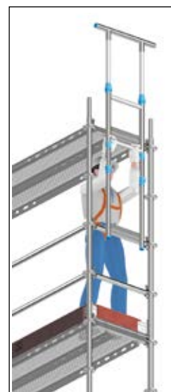
Montering av endestøtte
