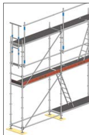
Montering av endestøtte
