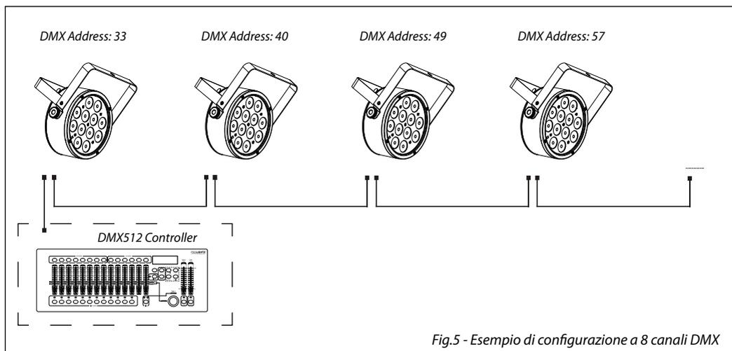
Fig.5 - Esempio di configurazione a 8 canali DMX
