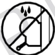
3.14 - Bruk ikke fett eller andre smøremidler på vinsjens bremsemekanisme. Bremseskivene er allerede satt inn med et spesielt varme-og trykkresistent smøre-middel. For å unngå skader på bremsemekanismen må det ikke brukes andre produkter.
