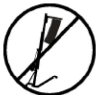
3.5 - Sjekk at stativet står loddrett og at støttesystemet (SA) er låst med låsepinnene og (R) og festeskruen(K).
