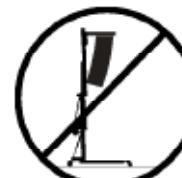
**3.4** - Stativet må ALDRI brukes til å heise opp gjenstander som ikke er forsvarlig sjekket. Kontroller at lasten er forsvarlig støttet opp og midtstilt på heisen slik at den heises opp utelukkende i vertikal retning.
