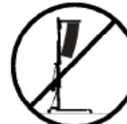
**3.4** - Stativet må ALDRI brukes til å heise opp gjenstander som ikke er forsvarlig sjekket. Kontroller at lasten er forsvarlig støttet opp og sentrert på heisen slik at den heises opp utelukkende i vertikal retning.
