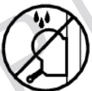
3.14 - Bruk ikke fett eller andre smøremidler på vinsjens bremsemekanisme. Bremseskivene er allerede satt inn med et spesielt varme-og trykk-resistant smøremiddel. For å unngå skader på bremsemekanismen må det ikke brukes andre produkter.
