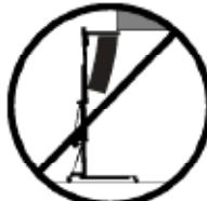
3.10 - Se opp for hindringer over stativet og umiddelbar nærhet av det, såsom gesimser, balkonger og neonskilt. **Viktig:** Stativet må plasseres og monteres slik at det ikke er noen form for wire under det.
