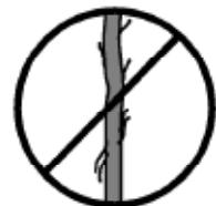
3.12 - Sjekk wirene før du bruker stativet. Wirene må ikke ha løse, avrevne tråder eller tegn på brekkasje eller flate områder. Bruk aldri defekte wire. Bytt ut dersom det er tvil. Bruk bare VMB vridningsstabile stålwire; referanse: DIN 3060. Kvalitet: 180KG/mm.
