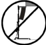
3.10 - Se opp for hindringer over stativet og umiddelbar nærhet av det, såsom gesimser, balkonger og neonskilt. **Viktig:** Stativet må plasseres og monteres slik at det ikke er noen form for wire under det.
