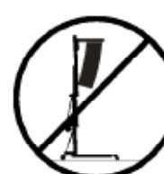
**3.4** - Stativet må ALDRI brukes til å heise opp gjenstander som ikke er forsvarlig sjekket. Kontroller at lasten er forsvarlig støttet opp og sentrent på heisen slik at den heises opp utelukkende i vertikal retning.
