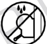
3.14 - Bruk ikke fett eller andre smøremidler på vinsjens bremsemekanisme. Bremseskivene er allerede satt inn med et spesielt varme-og trykkresistent smøre-middel. For å unngå skader på bremsemekanismen må det ikke brukes andre produkter.
