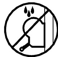
**3.14** – Ikke smør eller olje vinsjens bremsemekanisme. Bremseskivene er smurt med en varme og trykkbestandig spesialoppløsning. Bruk av andre produkter kan ha negativ effekt på bremsemekanismen.
