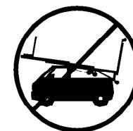
**3.13** – Før transport må alle seksjoner tas ned, og support systemet (**SA**) må låses med sprerrehaken (**R**).
